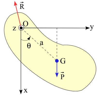
D'après le théorème du moment cinétique, le mouvement du pendule est donné par l'équation différentielle du second ordre:  $J_{\Delta} \ddot{\theta} = -Mga \sin \theta$  ou  $\ddot{\theta} + \omega_0^2 \sin \theta = 0$  avec  $\omega_0 = \sqrt{\frac{Mga}{J_{\Delta}}}$ .
